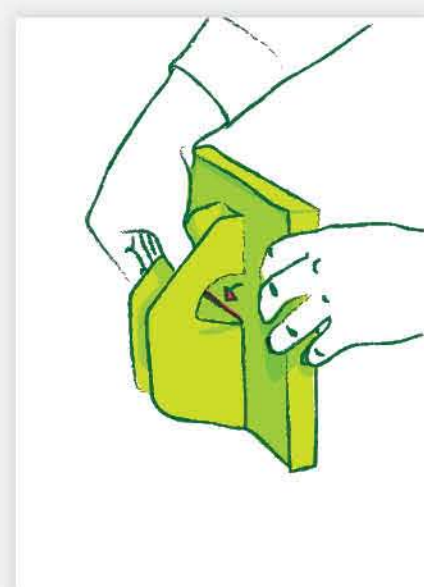
6: Verrouiller les supports en rabattant la languette
